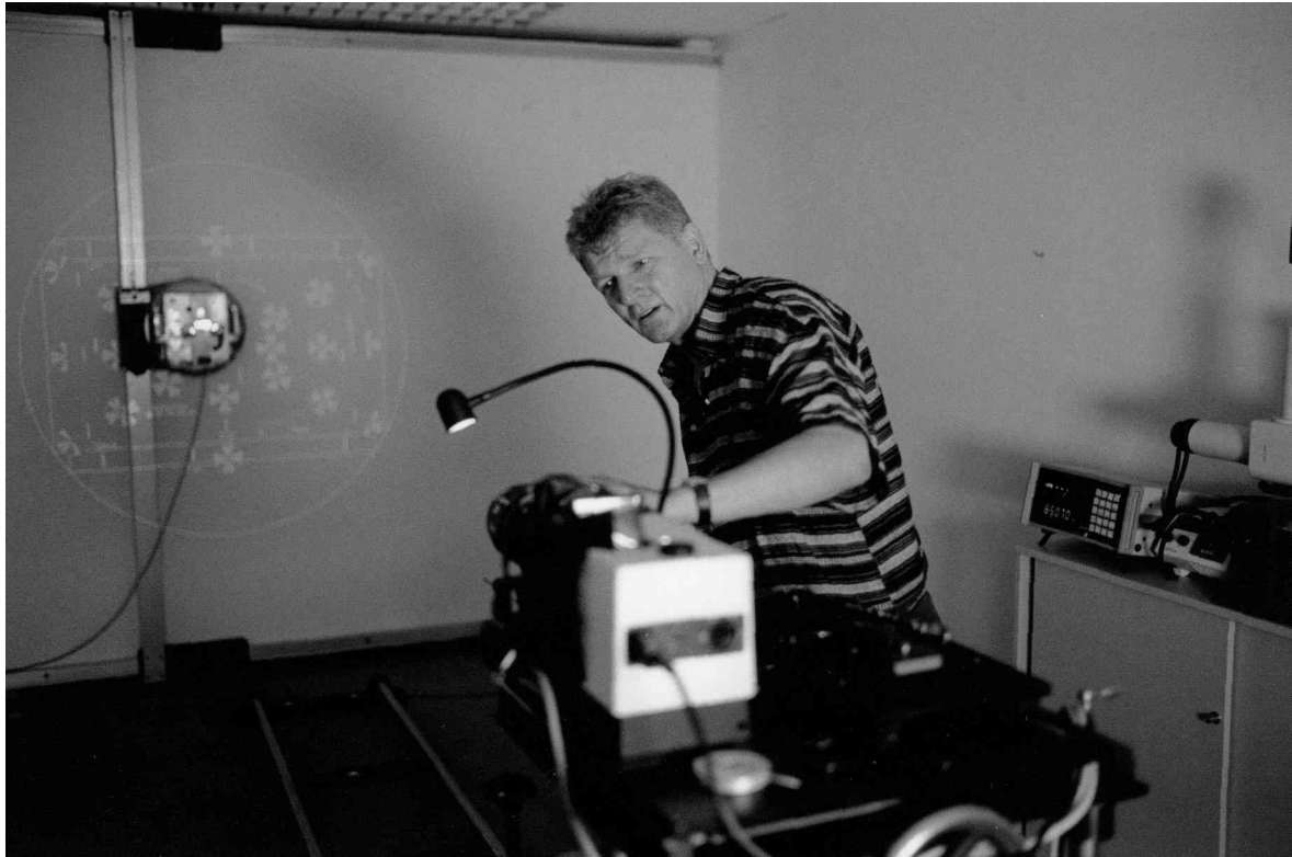
Testraum bei Chrosziel Filmtechnik mit Prüfprojektor und MTF Messgerät
